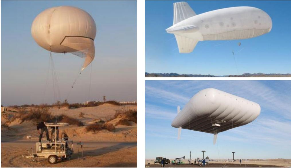
**Figure 2-1. Aerostat Envelopes**
